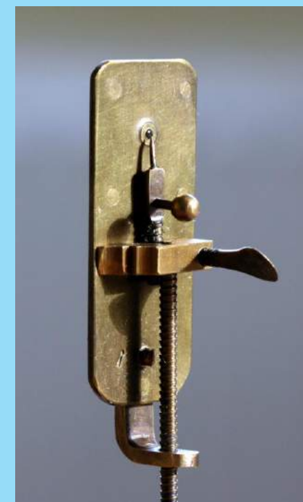
Микроскоп Левенгука с увеличением до 300x.
